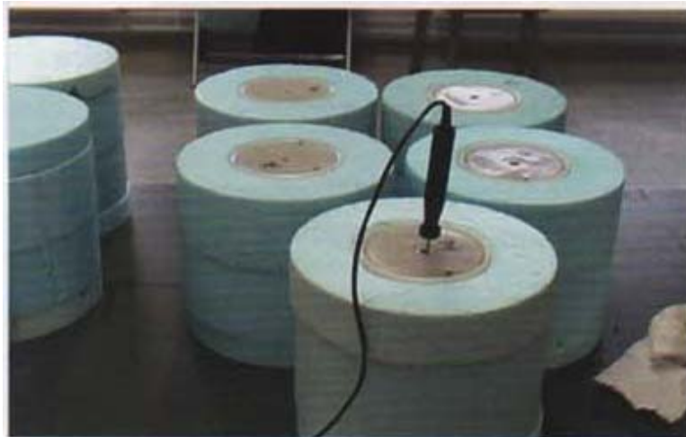
Messung der aeroben Stabilität nach Honig
